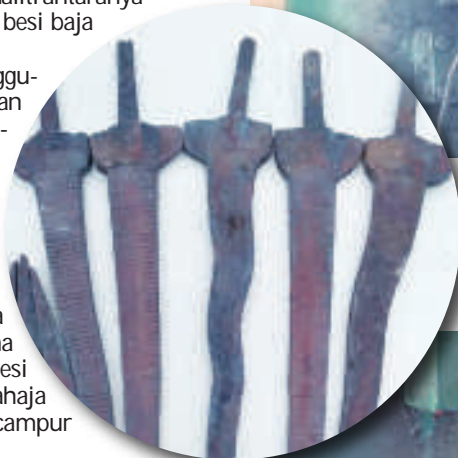
ANTARA 'bekalan' keris atau pra-keris, sebelum proses membentuk luk, mencanai dan sebagainya bagi membentuk sebilah keris yang sempurna.
